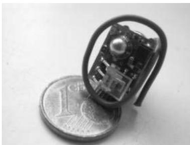
**Figure 1: A μPart Sensor Node (1 cm<sup>3</sup> incl. battery)**
