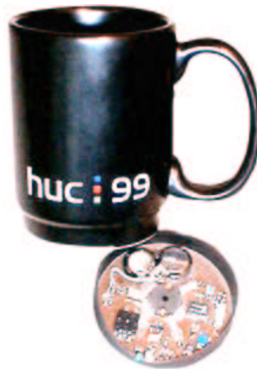
Abbildung C.1: Die MediaCup: “Clevere” Kaffeetasse mit abgenommener Elektronikmanschette
