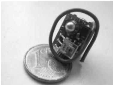
**Figure 1: A μPart Sensor Node (1 cm<sup>3</sup> incl. battery)**
