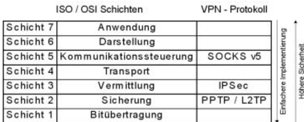
Abbildung 5: Einordnung der VPN-Protokolle im ISO/OSI-Basisreferenzmodell
